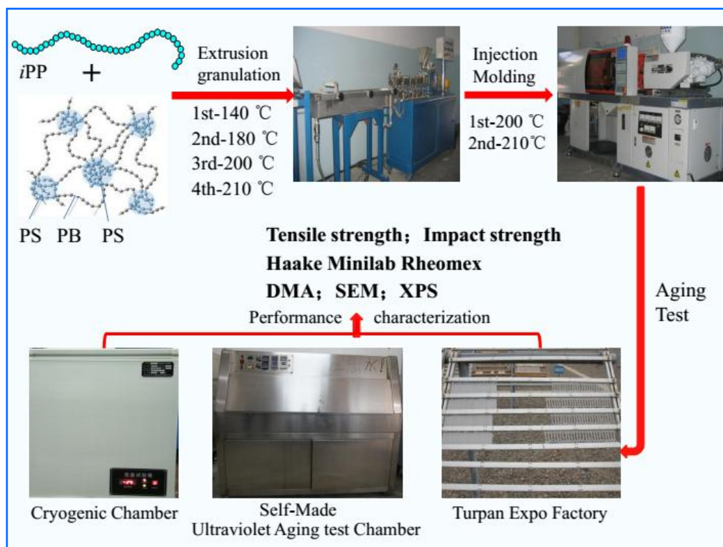
图 28 PP/SBS 共混物试样室内外温差老化性能研究
