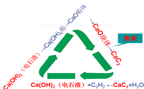
图 2 电石渣循环利用开发的过程示意图
